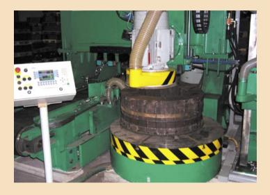
Получение изделий с очень незначительными отклонениями по размерам требует использования механической обработки огнеупоров.
