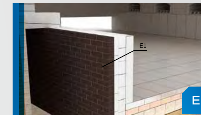
Zewnętrzna warstwa ściany ogniowej pieca Outer layer of superstructure walls Außenseite der Glasschmelzwanne Наружный слой стекольного бассейна
